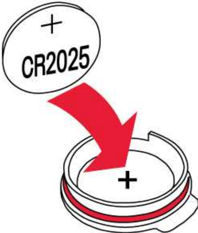
4. Assurez-vous que le joint d'étanchéité rouge est en place, propre et intact. Si le joint d'étanchéité est endommagé, remplacez-le par un neuf.\*
