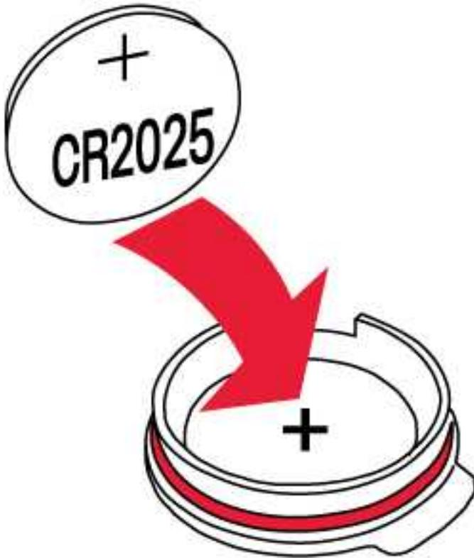
4. Assicurati che la guarnizione rossa sia al suo posto, pulita e intatta. Se la guarnizione è danneggiata, sostituiscila con una nuova\*.
