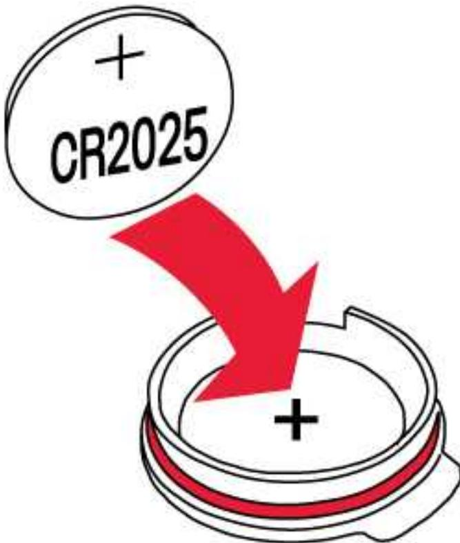
4. 赤いシーリングリングが所定の位置にあり、きれいで無傷であることを確認します。シーリングリングが損傷している場合は、新しいものと交換してください。
