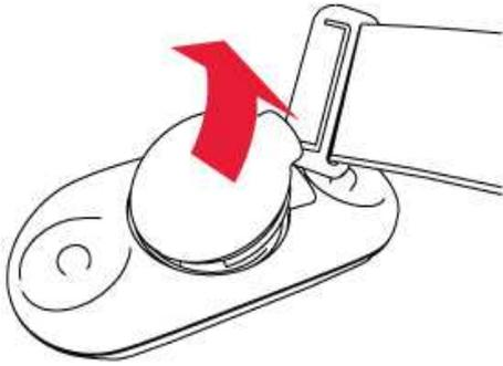
2. Entferne die alte Batterie aus der Batterieabdeckung.
