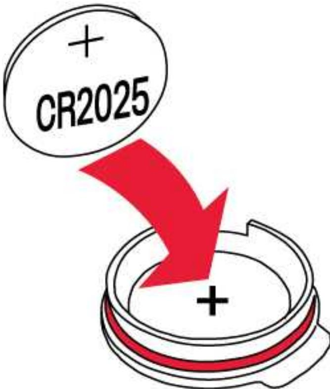
4. Vergewissere dich, dass der rote Dichtungsring vorhanden, sauber und unversehrt ist. Wenn der Dichtungsring beschädigt ist, ersetze ihn durch einen neuen\*.
