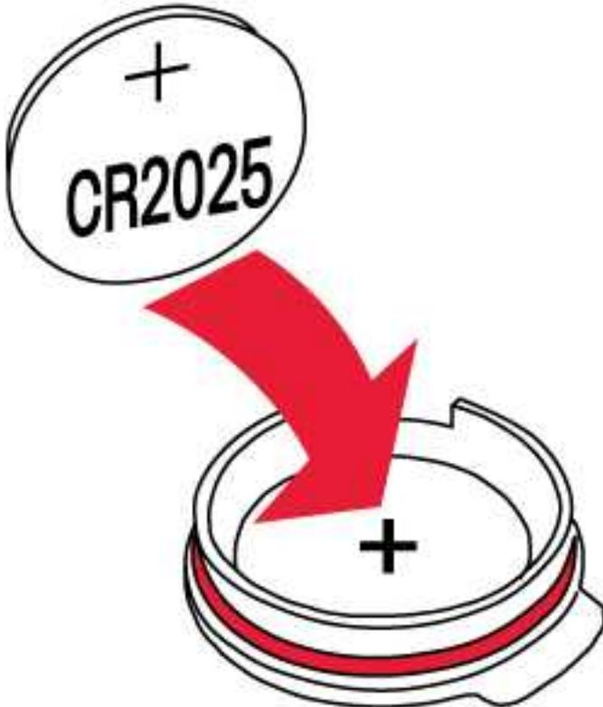
4. Asegúrate de que la junta de estanquidad roja está en su sitio, limpia e intacta. Si la junta de estanquidad está dañada, sustitúyela por una nueva\*.
