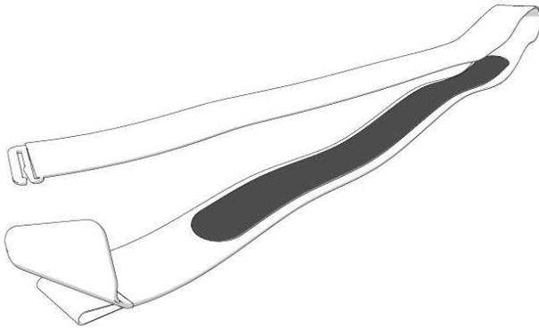
2. Le **connecteur** envoie le signal de fréquence cardiaque au dispositif de réception.
