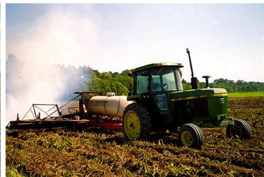
圖十、在薄荷田使用丙烷燄，殺死 *Verticillium* 的菌核 圖十一、在馬鈴薯田使用丙烷火焰防止馬鈴薯晚疫病感染
