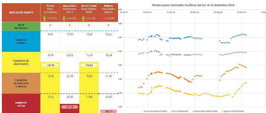
Ilustración 51 A). Gráfica del Nivel del Agua subterránea de los Acuíferos de la Costa Sur al 24 de septiembre de 2015. B) Gráfica de los niveles en los pozos centinelas de los acuíferos del sur hasta diciembre 2016.
