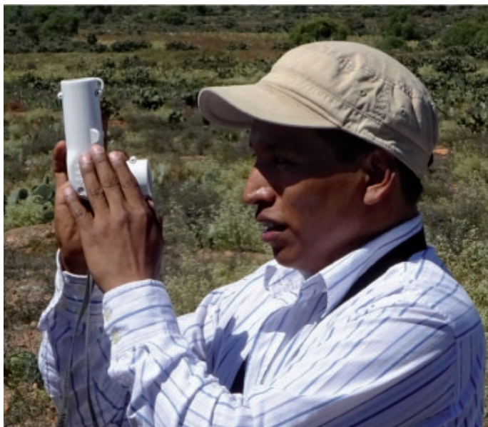
Uso de Densitómetro GRS en el campo
