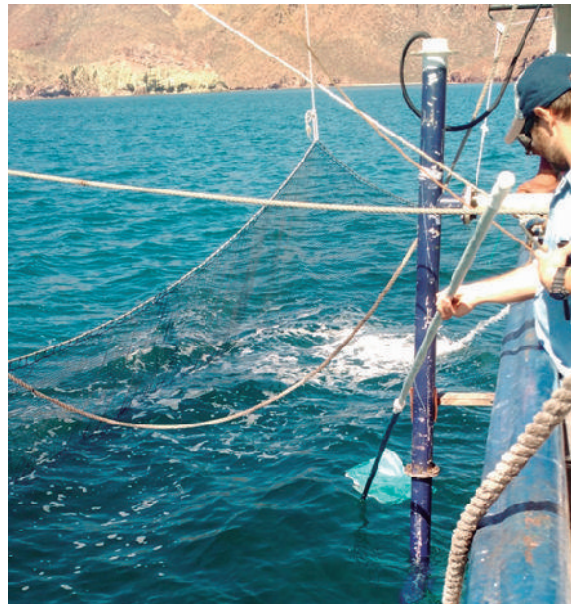
Fig. 5.8. Colocación de juveniles de totoaba dentro del bolso de red para determinar su blanco acústico.
