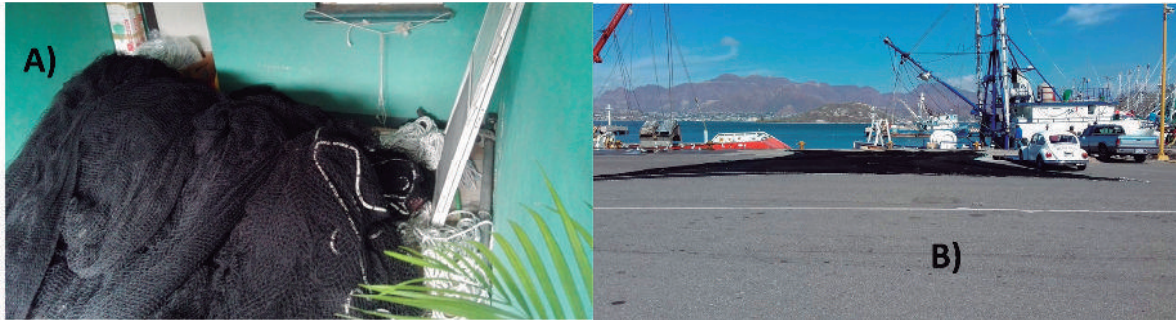
Fig. 5.1. Bolso cúbico de paño de red para realizar las determinaciones del blanco acústico de las totoabas vivas. A) Detalle; B) Bolso desplegado en el muelle, junto al BIP XI.
