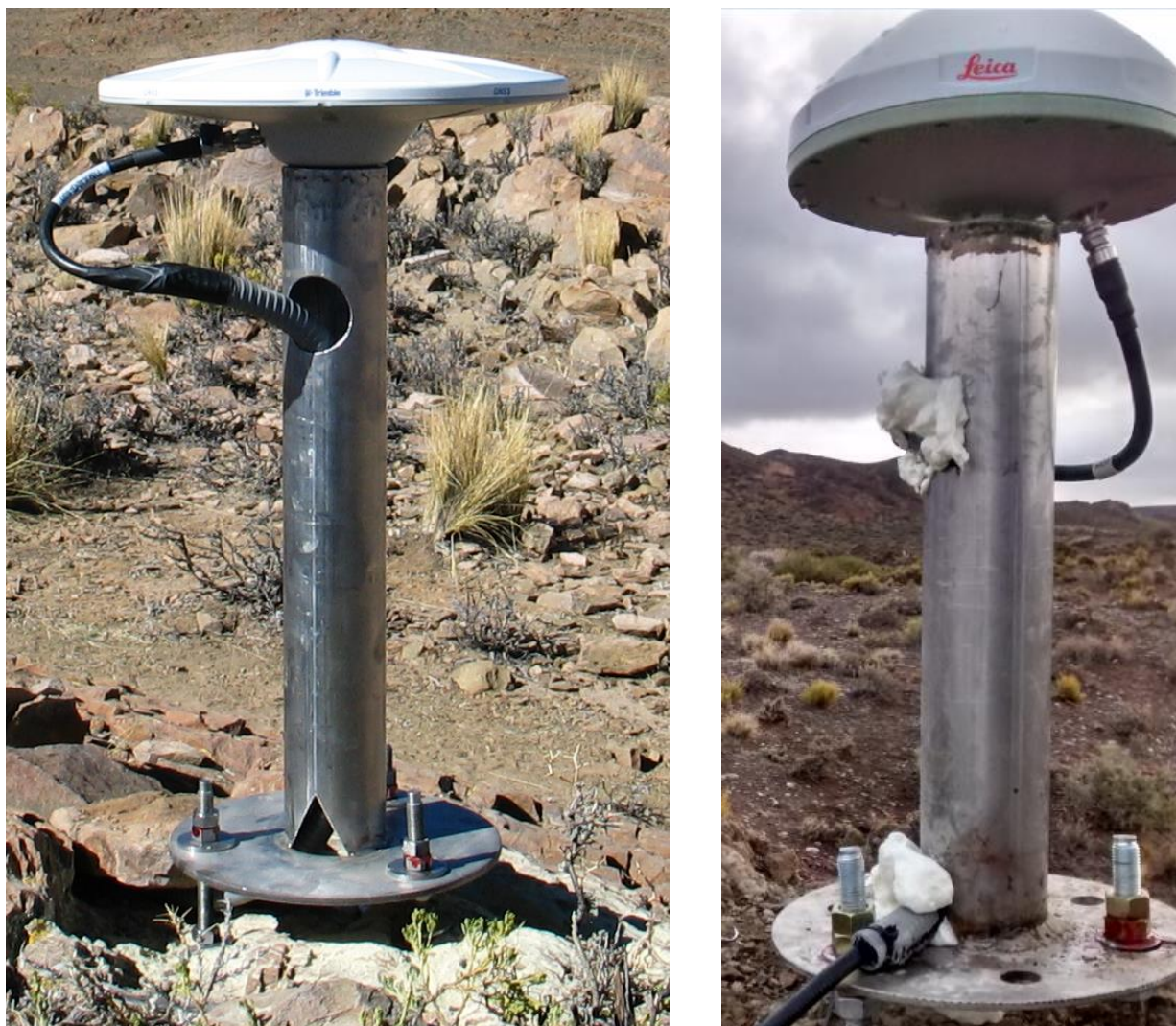
Fig. 16: Colocación de tornillo y arandelas
