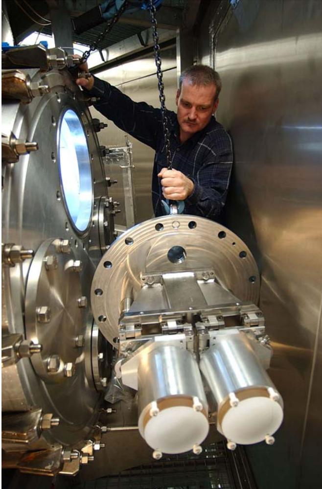
*Mit einem Laser-Absorptionsspektrometer werden in der Aerosolkammer AIDA des Forschungszentrums Karlsruhe verschiedene Spurengase, insbesondere Wasserdampf, gemessen, die mit den Aerosolpartikeln reagieren.*
