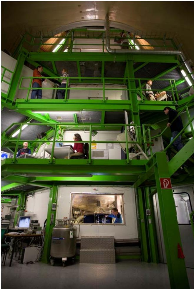
*Über mehrere Stockwerke erstreckt sich die Aerosolkammer AIDA im Institut für Meteorologie und Klimaforschung des Forschungszentrums Karlsruhe. Der zwischen -90 °C und +60 °C thermostatisierbare Aluminiumbehälter, dessen Boden im unteren Fenster zu erkennen ist, wird von einem weißen Isoliergehäuse ummantelt.*
