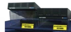
リチウムイオン電池充放電検査装置
