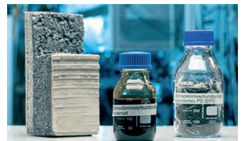
Recycling von Gebäudedämmung: Wärmedämmverbundsystem, zerkleinert und zurückgewonnen als Pyrolyseöl. (M. Breig, KIT)
