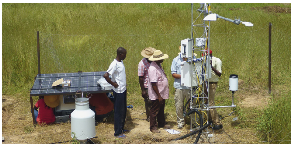
Aufbau einer Eddy-Kovarianz Klimastation in Ghana im Rahmen des BMBF geförderten WASCAL Programms. (Foto: H. Kunstmann)
