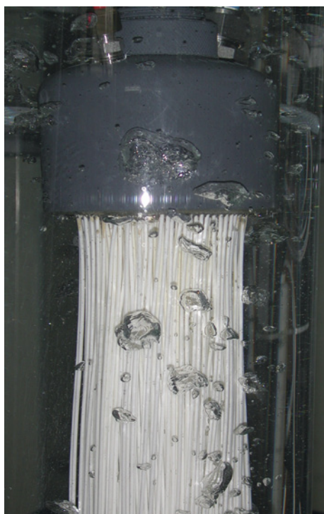
Was aussieht wie Sphagetti sind Membranen. Solche Hohlfasermembran-Module können zur Abwasserbehandlung eingesetzt werden. (Foto: F. Saravia)
