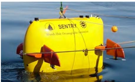
图2 WHOI Sentry AUV: 长 2.9 m, 高 1.8 m, 中央厚度 0.8 m (图引自 <http://www.whoi.edu/page.do?pid=38095&tid=201&cid=39036&ct=362#>)。
