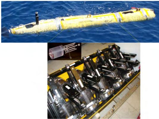
图1 MBARI Dorado AUV 长 4.2 m, 中央截面直径 0.53 m。在 AUV 中段装有 10 个快速水样采集器 (Copyright MBARI. 上图摄影: 本文作者; 下图摄影: Larry Bird and Alana Sherman)。
