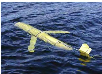
图3 Slocum 水下滑翔机: 长 1.5 m, 中央截面直径 0.2 m, 翼展 1.2 m<sup>[1]</sup> (图引自 <http://www.webbresearch.com/electricglider.aspx>)。
